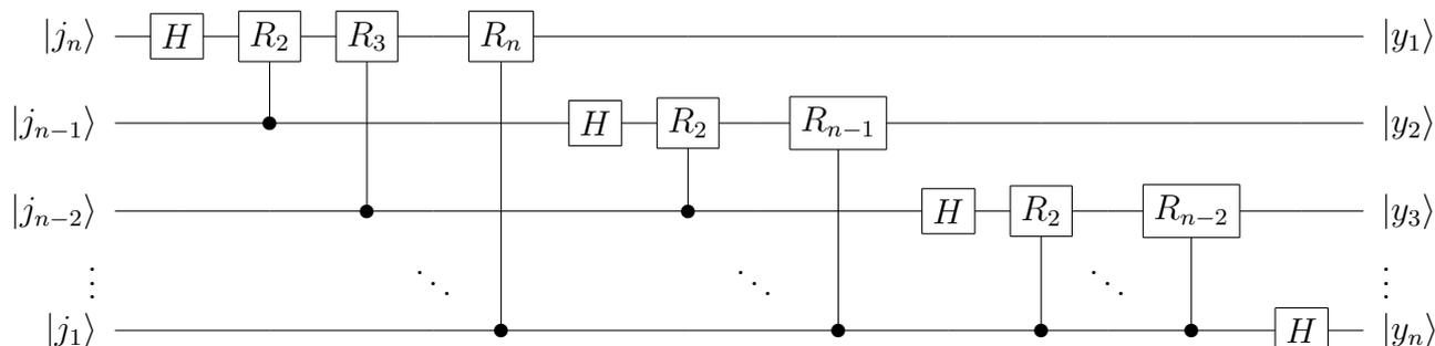
于是，这样就可以完成量子傅里叶变换，将两个乘数的傅里叶变换点值相乘，就得到了积的多项式点值，进而可以利用量子运算可逆的性质方便地进行量子傅里叶逆变换，只需要将刚刚的操作完全反转即可，其电路为
