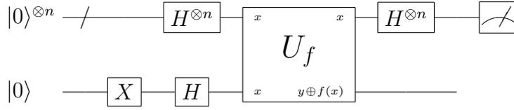
图 2.2: Deustch-Jozsa 算法的量子电路
